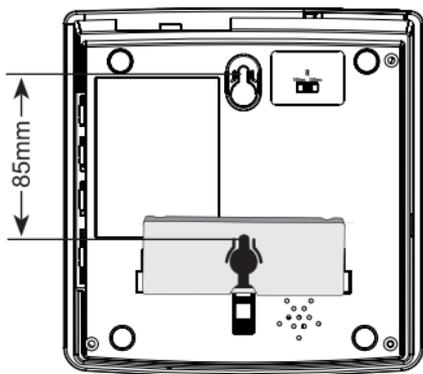
2. En línea vertical taladre dos orificios en la pared, uno encima del otro y separados a una distancia de 8,5cm. Inserte tacos y tornillos en los dos orificios. Las cabezas de los tornillos deben sobresalir 5 milímetros.
